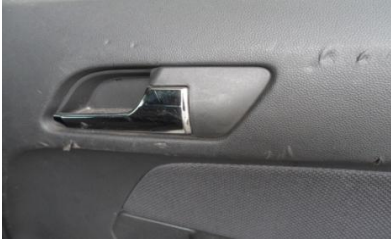
Portierbekleding beschadigd Niet acceptabel
