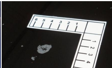
Lakschade als gevolg van zuren of harsen Niet acceptabel
