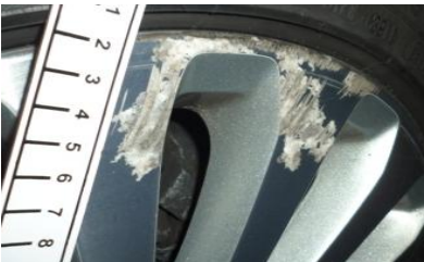
Beschadiging over meerdere spaken Niet acceptabel
