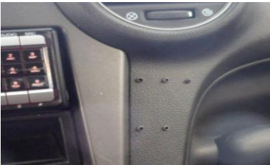
Schroefgaten als gevolg van demontage carkit Niet acceptabel
