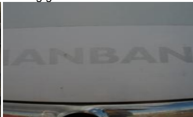
Kleurverschil na verwijderen reclame Niet acceptabel
