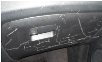
Diepe krassen dashboardklep Niet acceptabel
