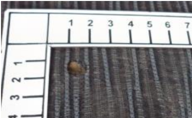
Brandgat in stoelbekleding Niet acceptabel
