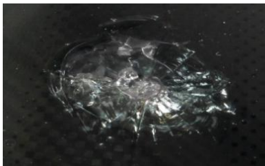
Sterretje welke niet meer hersteld kan worden middels hars injectie Niet acceptabel
