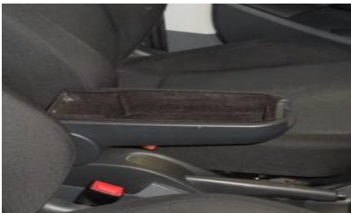
Midden armsteun afgebroken Niet acceptabel
