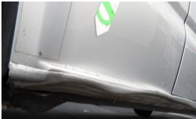
Onderzijde schade als gevolg van obstakel Niet acceptabel
