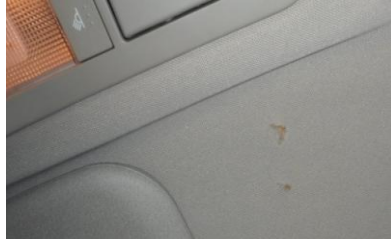
Beschadiging hemelbekleding Niet acceptabel
